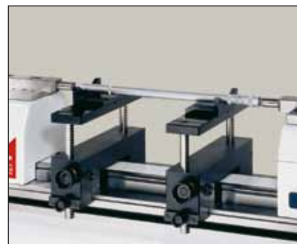
Etalonnage de micromètres d'intérieur à 2 points (HPA-1/TELMA7/TELMN7.2)
