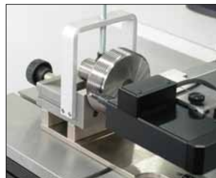
Etalonnage de tampons à filetage conique (TA-MS-381/TEL75)
