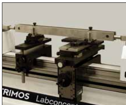
Contrôle comparatif de cales-étalons > 250 mm (TA-SU-313/TELMA7/P/ TA-SU-305/TA-SU-306)
