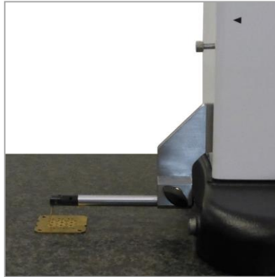
Mesure de hauteurs sur platine de montre
