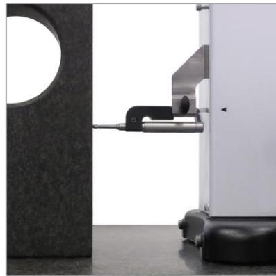
Mesure de perpendicularité avec palpeur électronique
