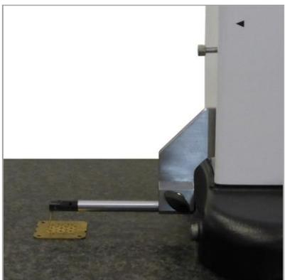
Mesure de hauteur sur platine de montre
