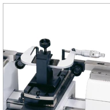
Etalonnage de micromètres
