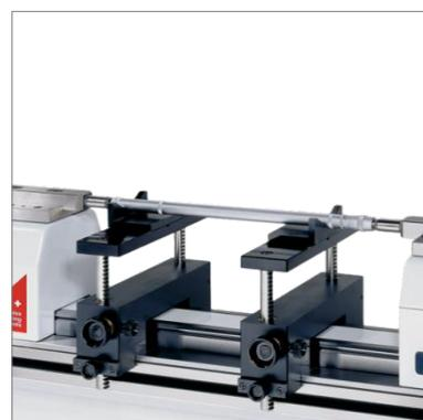
Etalonnage de micromètres
