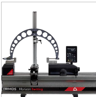
Contrôle de grands micromètres avec support (TA-SU-313, LABC20.1/SP02, TEL5)
