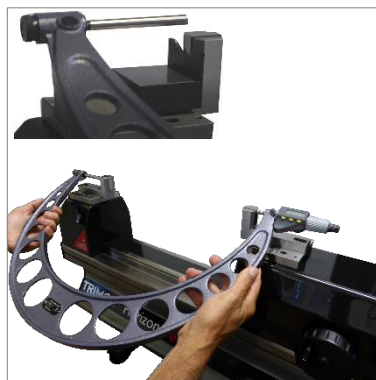
Contrôle manuel de grands micromètres (TEL5)(TEL11)
