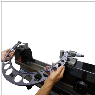
Contrôle manuel de grands micromètres (TEL5, TEL11)
