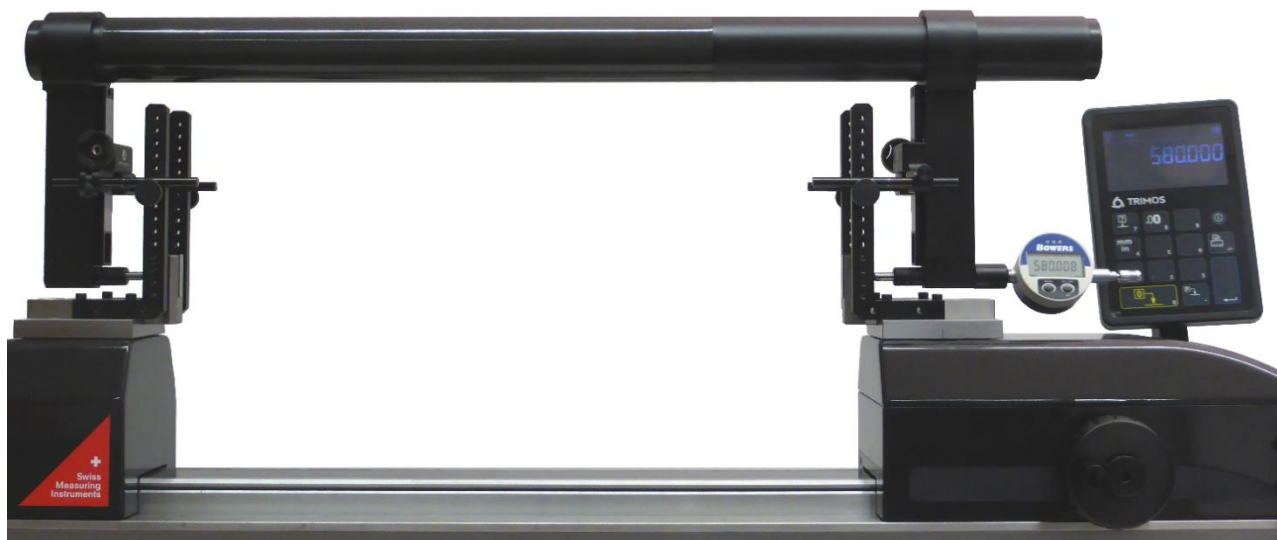
Étalonnage d'une jauge de grande dimension
