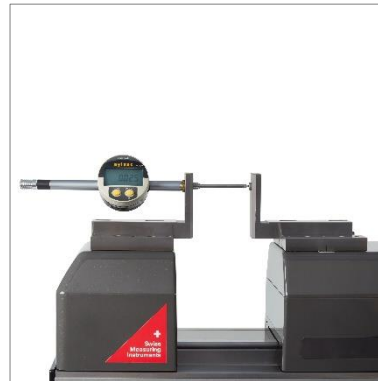
Contrôle de comparateurs (de 0 à 300mm) (TEL 5CN)
