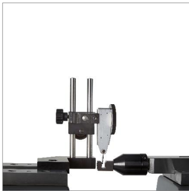
Contrôle de comparateurs à levier (TULM 15.1)
