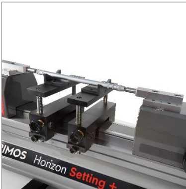
Instrument de mesures comparatives à deux points (TELMA7)
