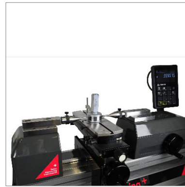
Contrôle de tampon lisses (de 30 à 250mm) (TEL6, TA-SU-313, TULM6/L0.5, TA-SU-304)
