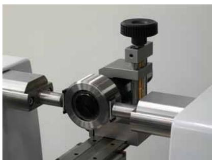
Étalonnage d'un tampon fileté
