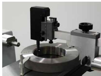
Contrôle d'une bague filetée
