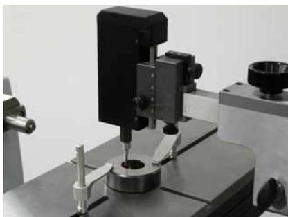
Étalonnage d'une petite bague lisse
