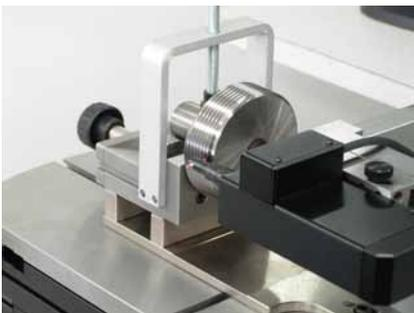
Etalonnage d'un tampon à filetage conique
