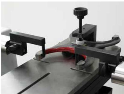
Contrôle d'un calibre-mâchoire
