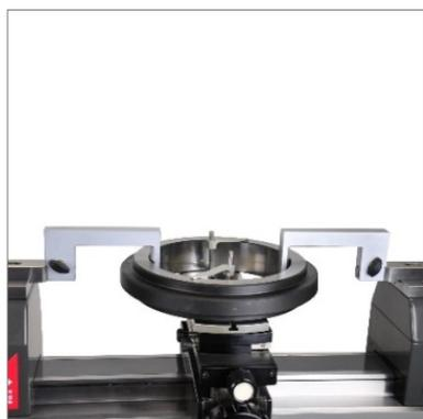
Contrôle d'une bague lisse
