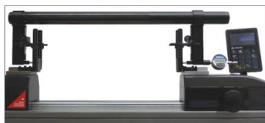
Etalonnage d'une jauge de mesure
