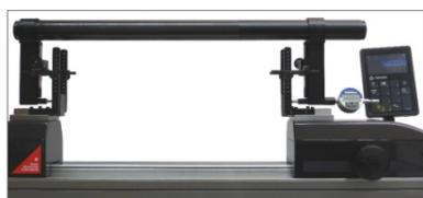
Etalonnage d'une jauge de mesure
