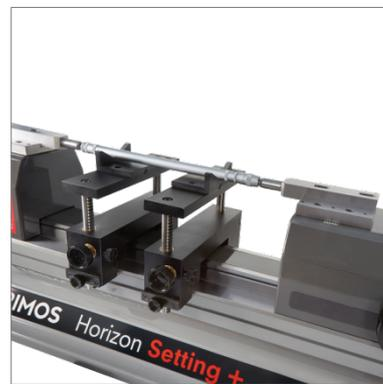
Vérification de micromètres d'intérieur à 2 points (HPA-1, TELMA7, TELMN7.2).
